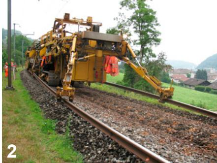
2 Ausbau der Gleise mit Puma-Umbauzug
