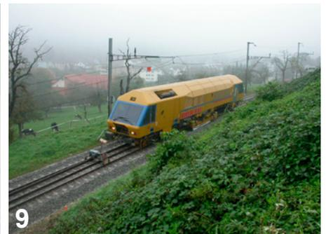
9 Schweißen der Schienen mit Scheuchzer Boa 811
